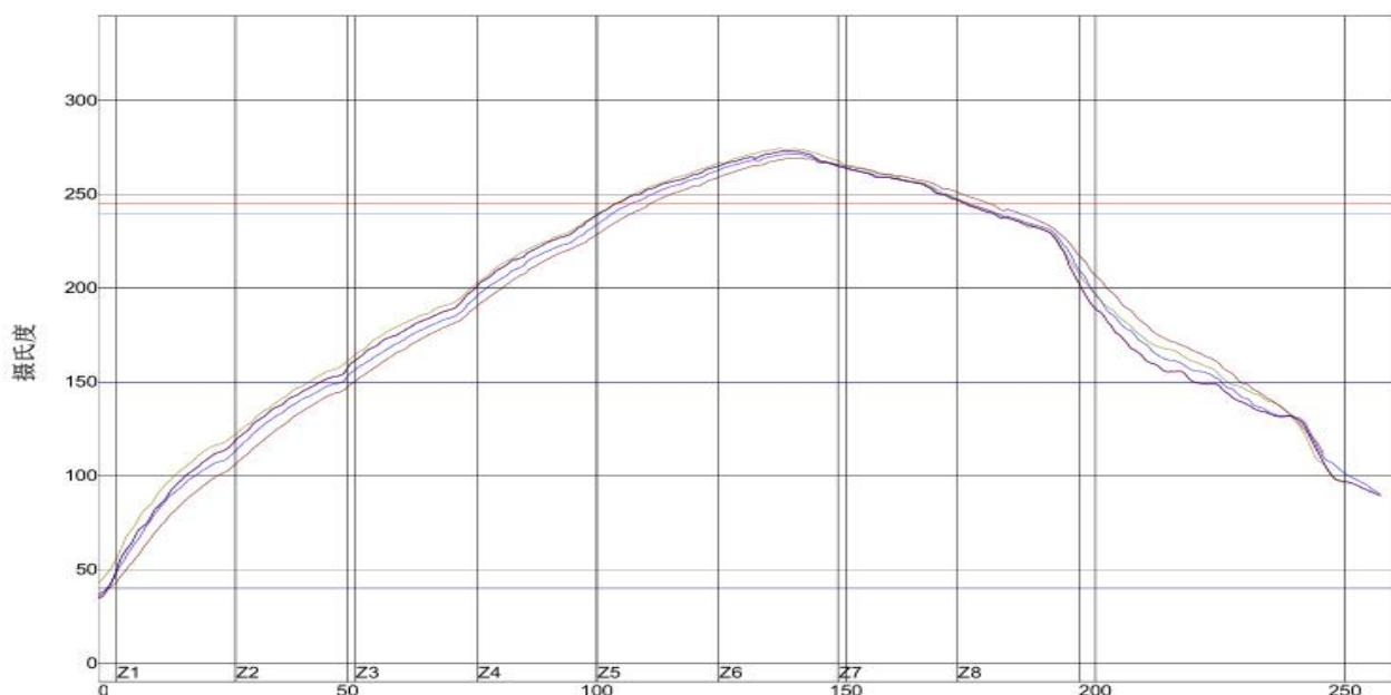
注 ☆上述回焊温度曲线仅供参考，可作为使用者寻找在不同制程应用之最佳曲线的基础。实际温度设定需结合产品性质、支架大小、芯片分布状况及特点、设备工艺条件等因素综合考虑，事前不妨多做试验，以确保曲线的最佳化。
