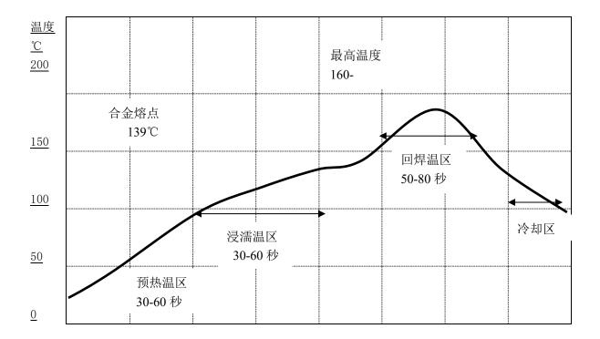
① 预热区(加热通道的 25~33%): 在预热区,焊膏内的部分挥发性熔剂被蒸发,并降低对芯片之热冲击。
