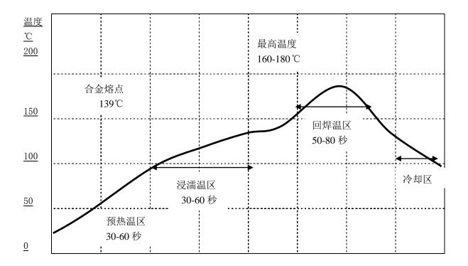
① 预热区(加热通道的 25~33%):在预热区,焊膏内的部分挥发性熔剂被蒸发,并降低对芯片之热冲击。要求:升温速率为 1.5~3.0℃/秒;若升温速度太快,则可能会引起锡膏的流移性及成份恶化,造成锡球及桥连等现象,同时会使芯片承受过大的热应力而受损。
